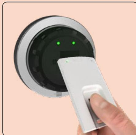
**1** Die biometrische RFID-Karte wird durch ein Auflegen eines Fingers auf den Fingerabdrucksensor aktiviert und der Fingerabdruck anschließend gescannt. Stimmt dieser mit dem hinterlegten Abdruck überein, leuchtet die grüne LED und die RFID-Karte wird (zeitlich begrenzt) aktiviert.
